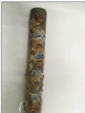
Opferanode zu etwa 80% mit Kalkschicht überzogen
